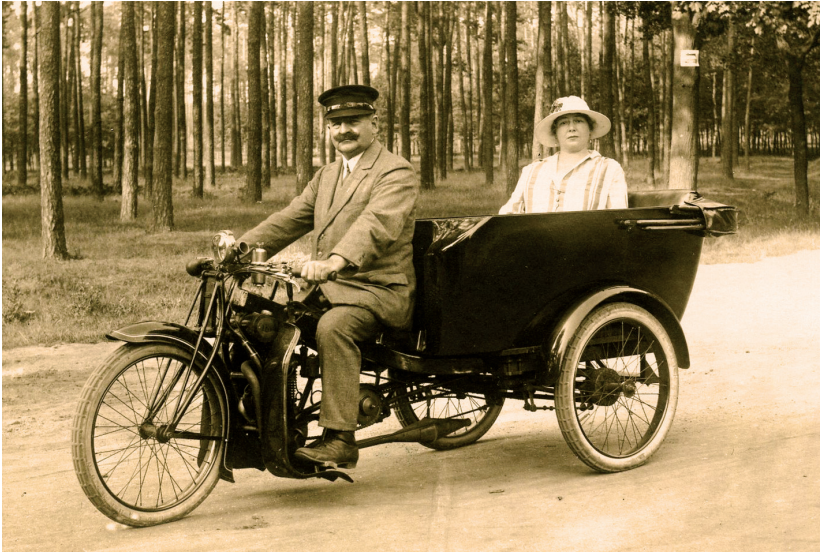
E.B.S. Motordreirad mit auswechselbarem Aufbau – hier mit offener Personenkarosserie
